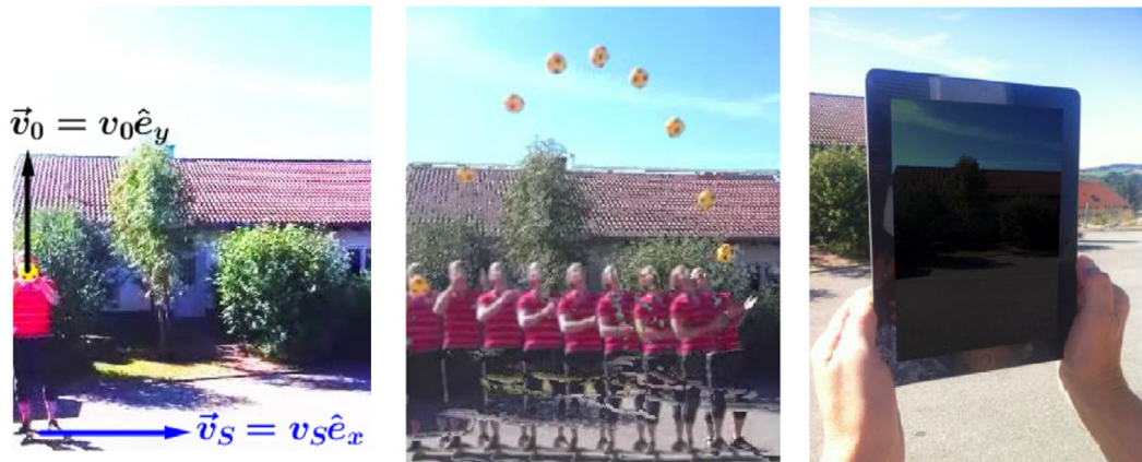
Abb. 5: Mobiles Analogie-Experiment zum Wagen-Kugel-Experiment aus Abb. 2: Ein Skateboardfahrer fährt mit konstanter Geschwindigkeit in x -Richtung und wirft einen Ball in y -Richtung (links bzw. mittig). Das Szenario wird mit einem Tablet-PC videografiert (rechts) und ausgewertet. Die Abbildung wurde aus Klein et al. (2013a) entnommen.
